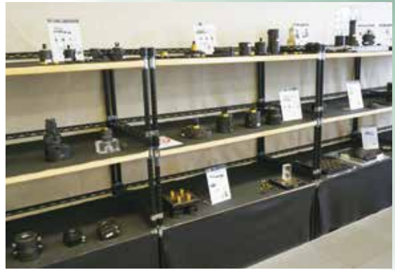
大型ワークを安全に高精度でクランプできる「FCS System」。モジュールの組合せでさまざまな加工シーンに対応する
