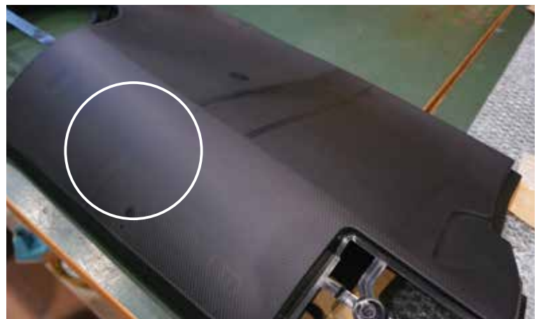
試作型による成形品。ウエルドライン(○部)を上ラインの延長線上来るようにコントロールしている
