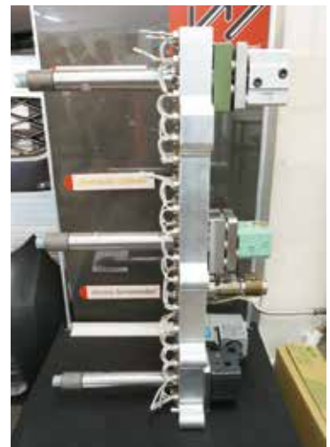
エア、油圧、電動の3種の駆動源を組み込める自社開発ホットランナー
